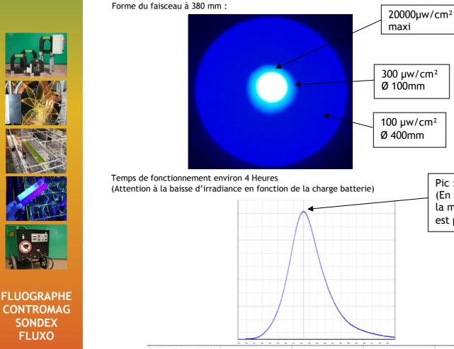
Pic: 366.53 nm (En supplément la mesure du pic est possible)
